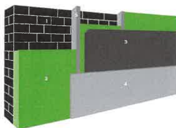
1. Buitenmuur | 2. Isolatie | 3. Vochtscherm | 4. Afwerkingslaag | 5. Stijl- en regelwerk (optioneel)
